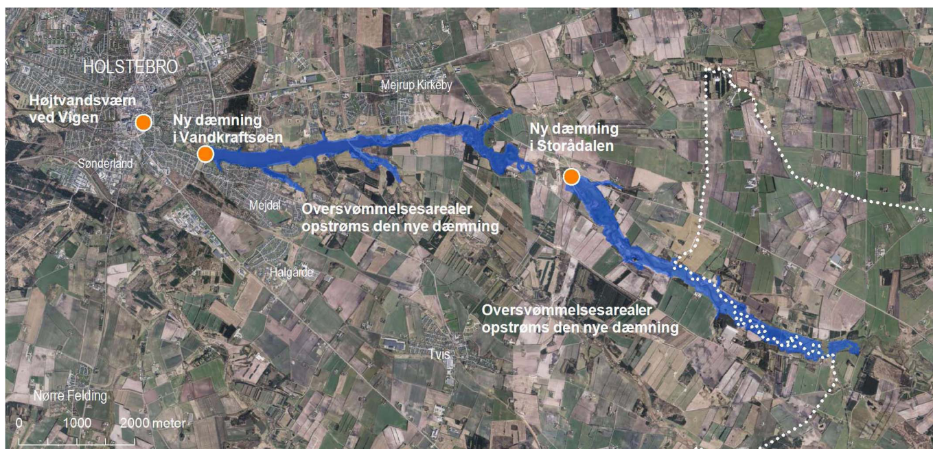
Figur 1. Klimatilpasningsanlæggets placering er markeret med orange, oversvømmelsesarealerne er markeret med blå og kommunegrænsen er markeret ved en hvid prikket linje.
